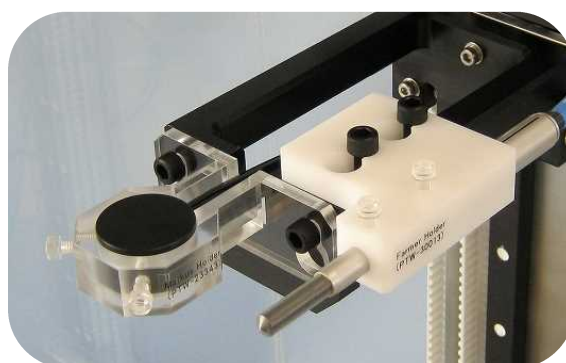
平行平板形用チャンバーホルダー取付時 ※相互校正用チャンバーホルダーはオプション
